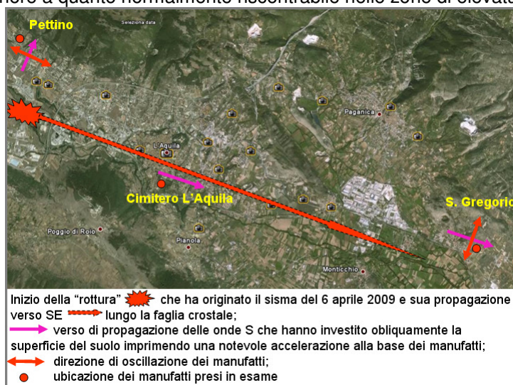
Figura 20: Ubicazione dei siti, caratterizzati da substrato che ha amplificato le sollecitazioni sismiche delle onde S che hanno investito obliquamente la superficie del suolo, nei quali sono stati rilevati effetti locali particolarmente significativi per la comprensione degli effetti che si possono verificare in area epicentrale "near fault". La distanza tra Pettino e San Gregorio è di circa 14 chilometri. Gli effetti locali rilevati a Pettino sono attribuibili all'incidenza delle onde S amplificate diramatesi in direzione normale a quella della faglia sismogenetica; quelli del Cimitero dell'Aquila e di San Gregorio sono riferibili alle onde S amplificate che si sono diffuse lungo la direzione di propagazione della frattura sismogenetica verso SE. I valori più elevati di accelerazione al suolo registrati strumentalmente (0,62g) dalla rete DPC sono stati rilevati nei pressi dell'inizio della rottura all'estremità nordoccidentale, che ha originato il sisma del 6 aprile 2009. Valori elevati (>0,40 g) sono stati calcolati nel Cimitero dell'Aquila, a San Gregorio e a Pettino, vale a dire in tutta l'area epicentrale "near fault".
