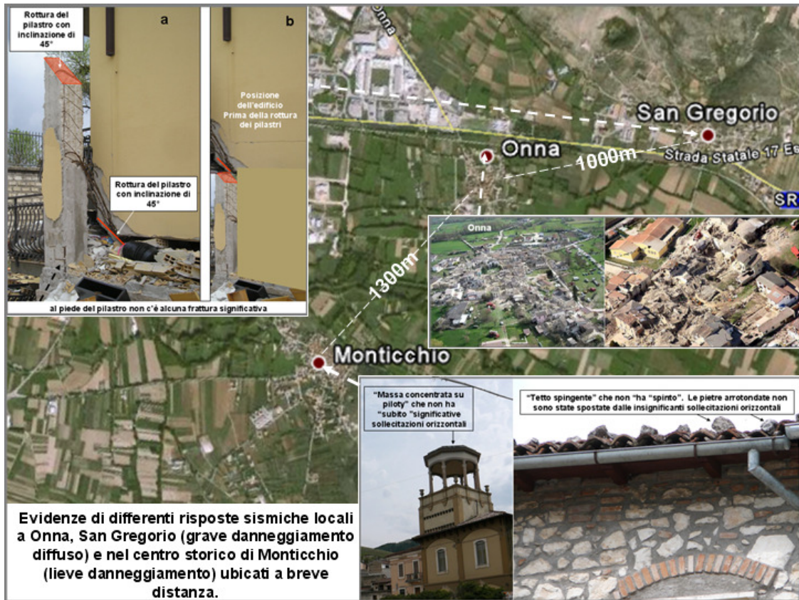
Figura 12: Esempi di effetti locali differenziati in relazione alle caratteristiche geotecniche del substrato a san Gregorio, Onna e Monticchio, centri abitati in zona epicentrale e a breve distanza gli uni dagli altri.
