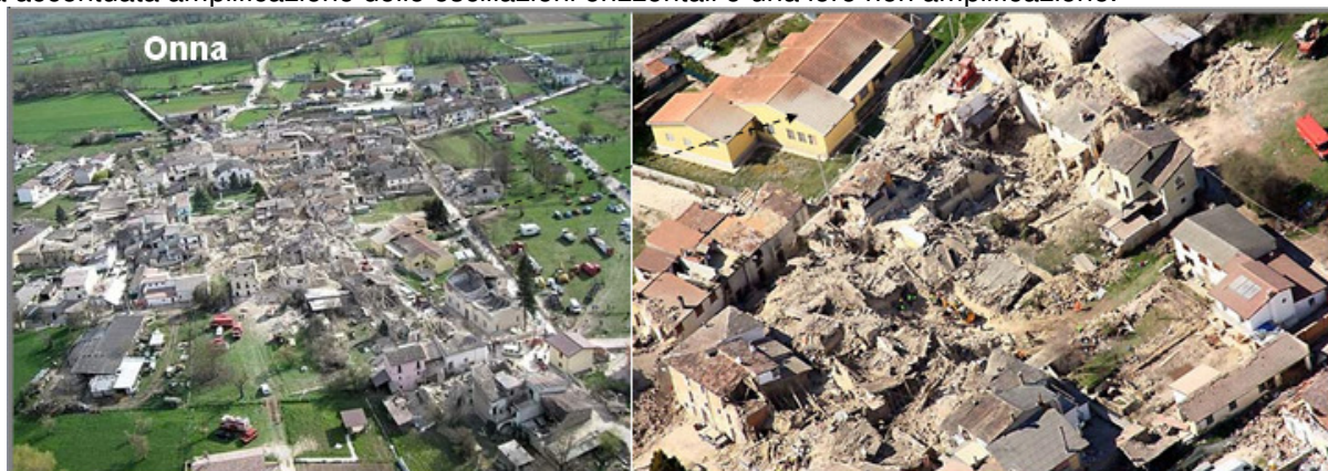
Figura 9: Zona di Onna nella pianura alluvionale del fiume Aterno. Le scadenti proprietà geotecniche dei sedimenti interessati da falda superficiale hanno determinato sensibili fenomeni di amplificazione sismica.
