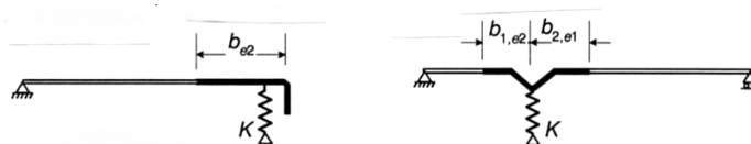
Figura C4.2.31 – Schematizzazione degli irrigidimenti
