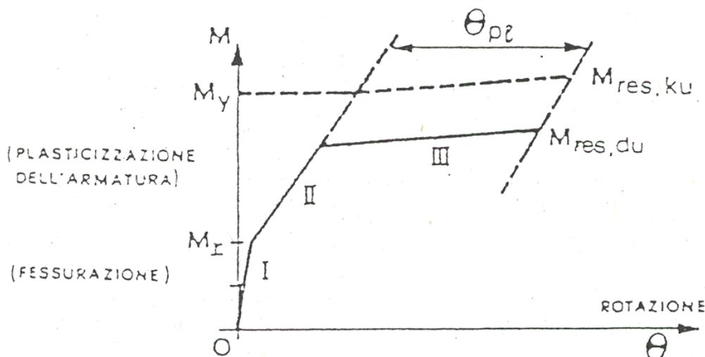
Fig. 1 - Diagramma momento-rotazione: idealizzazione tri-lineare
