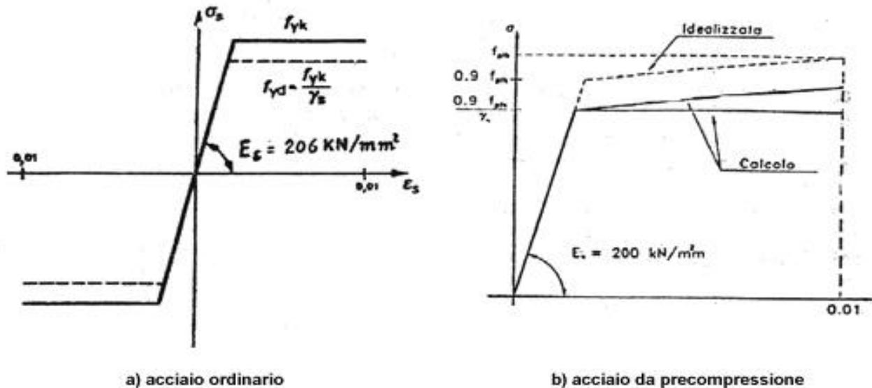
Fig.3 - Diagramma di calcolo s- e
